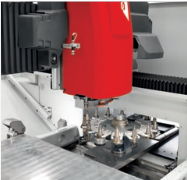
Almacén de herramientas giratorio en el que pueden cargarse las herramientas en condiciones de seguridad total mientras la máquina está trabajando.
