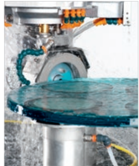
Amolado de taza con agregado.
