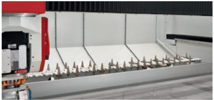
Almacén trasero de dos filas.
