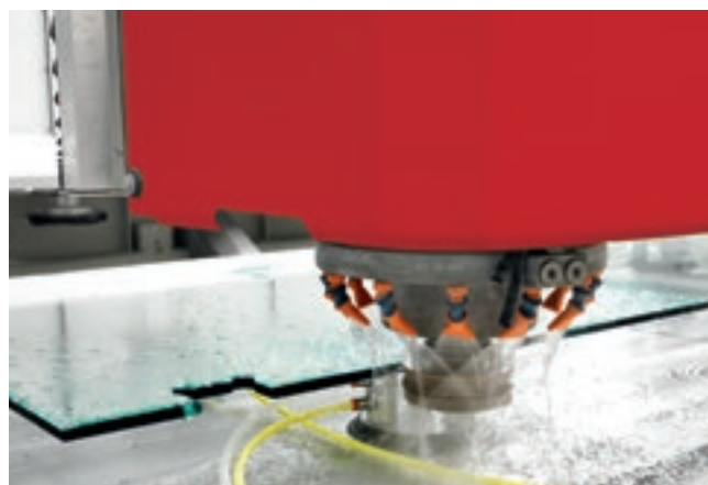
Amolado del canto periférico brillante.
